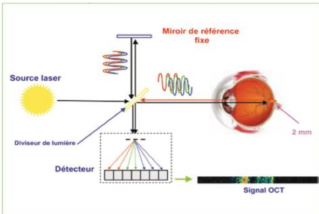
*Figure 17 : Technologie « Spectral Domain ».*
