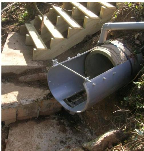
La station de mesure de BRVU mis en place depuis janvier 2012 à la sortie du réseau d'eaux pluviales du bourg de Bourville. Cette station est équipée d'un capteur hauteur-vitesse permettant de déterminer le débit instantanément.
