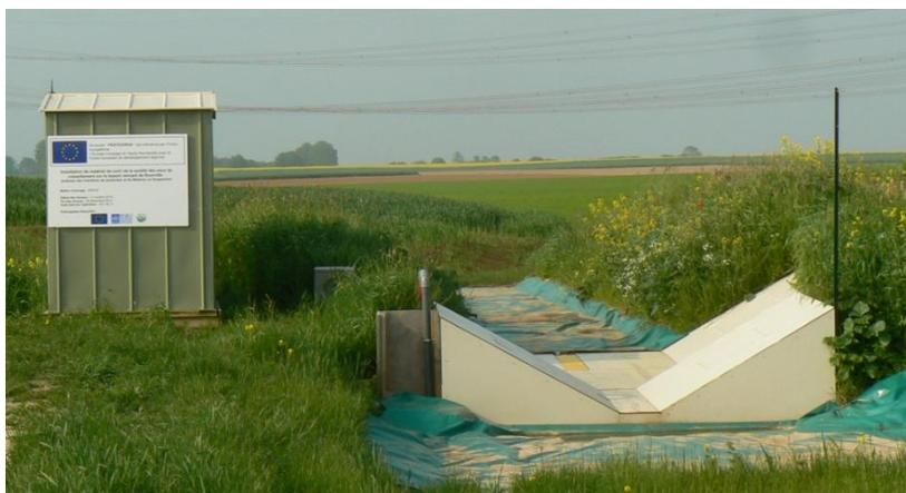
Photo du dispositif mis en place à FDTL : canal trapézoïdal super-critique (Source : AREAS)
