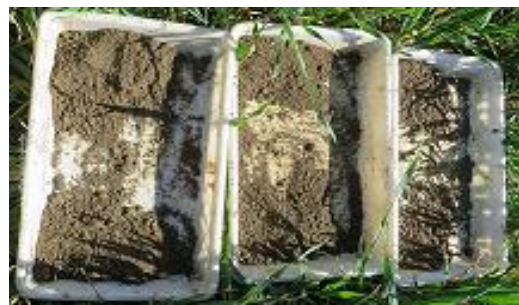
Figure 8 : Photographie du quartage des échantillons
