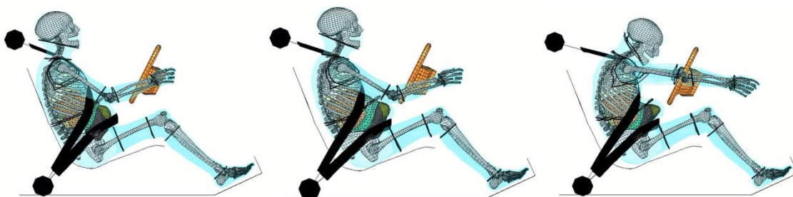
Figure 11, 12 et 13: Simulation numérique ceinture au milieu du ventre à T1s T4s et T8s
