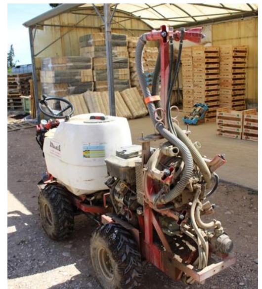
Figure 15 Pulvérisateur atomiseur avec 3 paires de buses à turbulence
