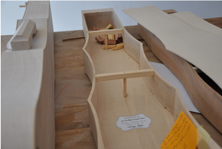
Figure 17 - Âme et renforts au niveau des courbures – tambourin de Serge Cladères – photographie de l’auteure (14 avril 2013)
