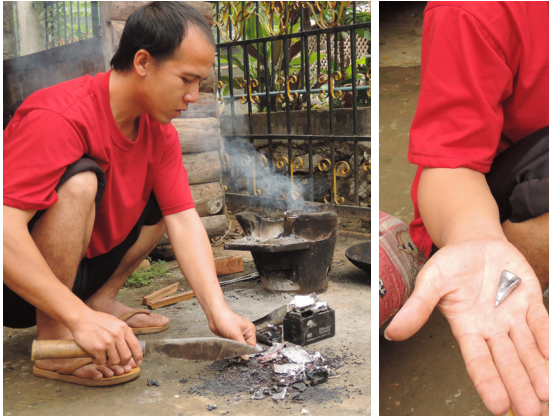
Fabrication artisanale d'un plomb de pêche, Luang Prabang, Laos, 14/12/2013 © Marc Boinet
