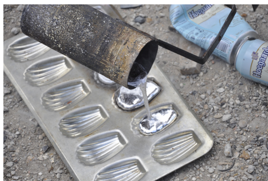
Première coulée d'aluminium extrait de canette, Actlab, Atelier de l'association Bellastock, Île St Denis, 08/05/2015 © Marc Boinet
