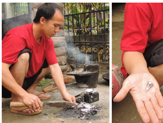
Fabrication artisanale d'un plomb de pêche, Luang Prabang, Laos,
