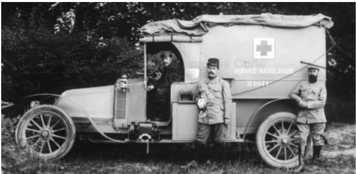
Voiture radiologique. 1915. On observe sur le marche-pied la dynamo permettant de fournir l'électricité aux différents appareils. ACJC.
