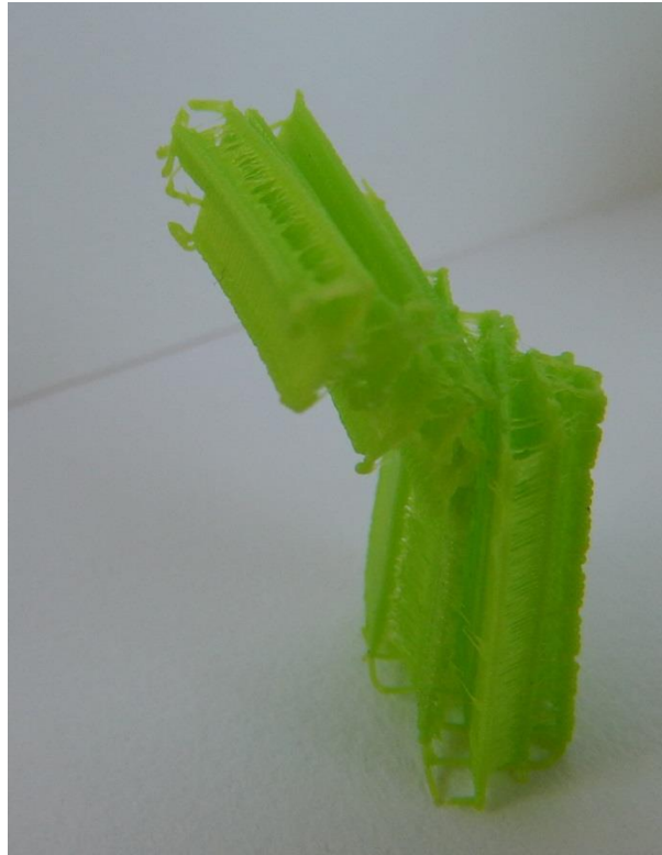
Essai d'application du chloroforme sur deux morceaux de PLA
