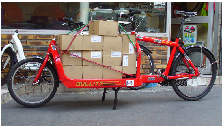
Figure 14 : Bicyclette type Long John, avec espace de chargement à l'avant / source : velotaf.com
