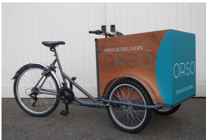
Figure 17 : Tricycle type Cargo Trike, avec espace de chargement à l'avant / source : Orso
