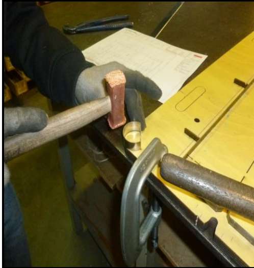
45- Insertion des éléments de renfort.
