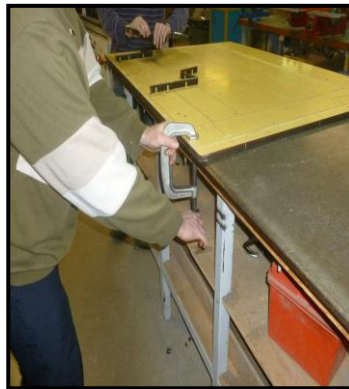
38- Fixation de la forme avec serre joints
