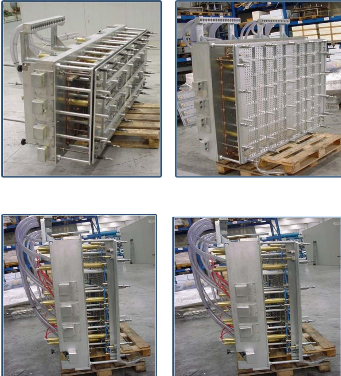
Figure 20 : Exemples de moules pour expansion du polystyrène
