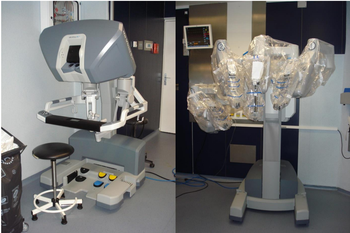
Figure 101. Console ergonomique du chirurgien et chariot situé du côté du patient du système chirurgical da Vinci® Si™.
