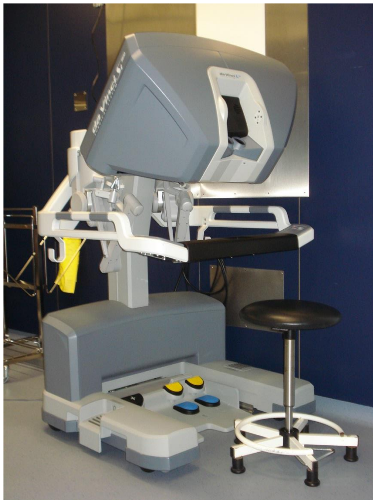
Figure 95. Console ergonomique du chirurgien.
