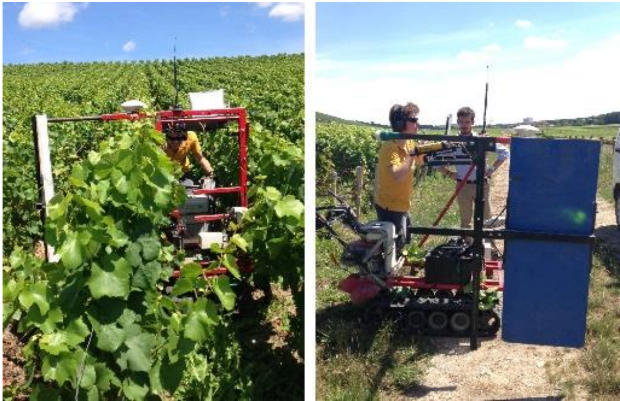
Figure 13 : Greenseeker monté sur chenillard dans la parcelle d'Aÿ (site 12) (Photographies, A. Reyes)
