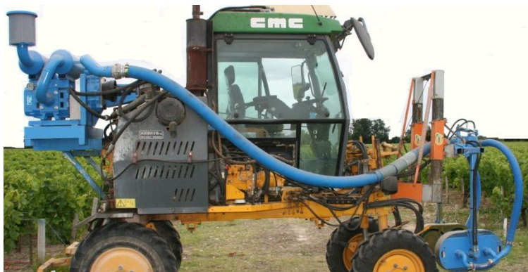
Figure 4 : Effeilleuse Ecojet (Photographie, matevi-France.com)
