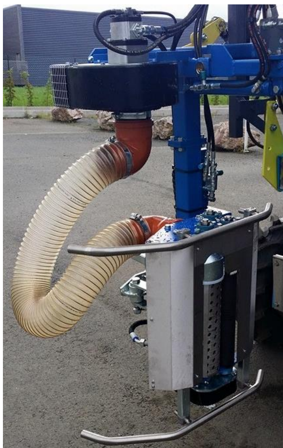
Figure 11 : Effeilleuse AWS Stockmayer (Photographie, Faupin.com)
