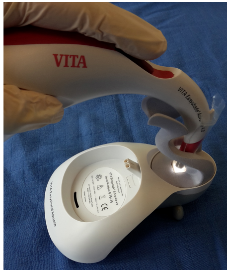
Figure 20 : Etalonnage du VITA Easyshade Advance 4.0.
