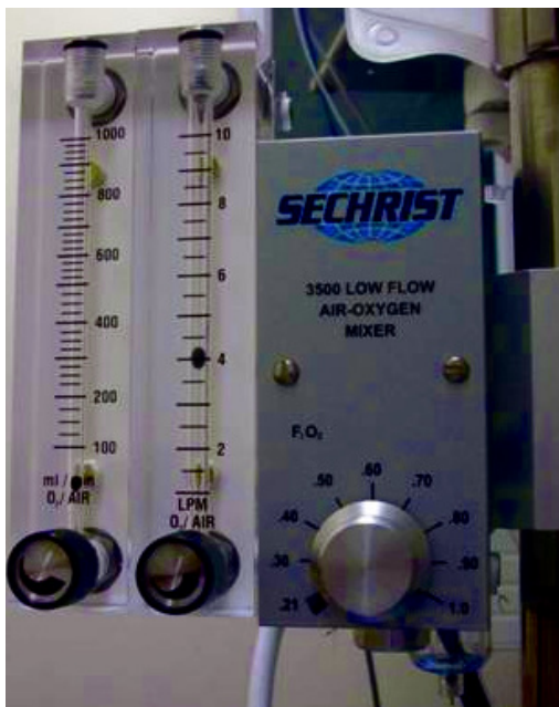
Figure 9 Un mélangeur de gaz. Les deux colonnes de gauche permettent de régler le débit de balayage et le bouton rotatif à droite permet de régler la FiO_2 du gaz de balayage (de 21% à 100%).
