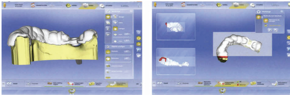
Figure 19 : De gauche à droite : modèle virtuel du guide chirurgical, programmation du guide chirurgical dans son bloc à usiner (Bindl, 2015)
