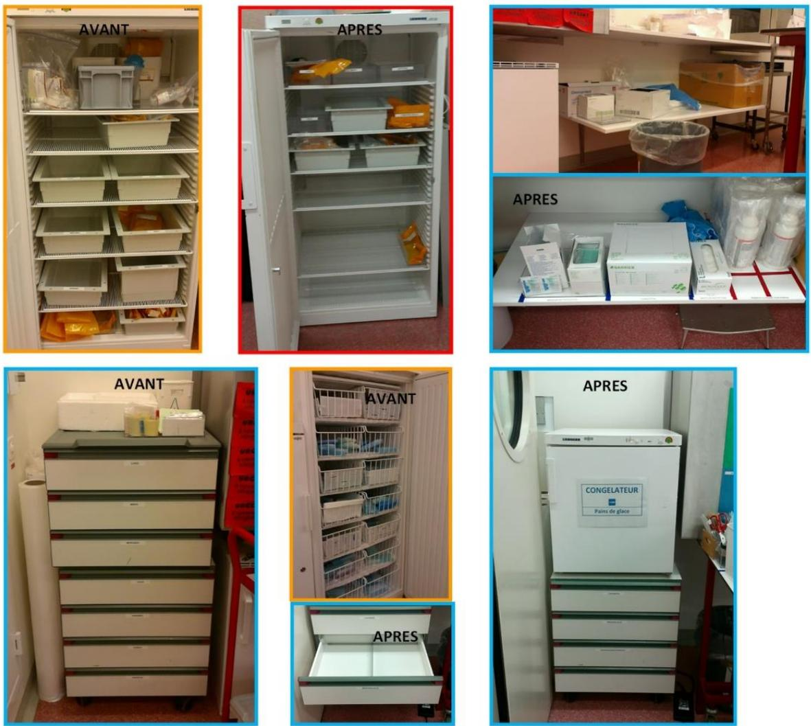
Le congélateur disproportionné est échangé pour un petit congélateur, qui rejoint la nouvelle zone d'expédition. Le stockage des préparations réalisées à l'avance est diminué, dans les étagères et dans le réfrigérateur. Ce réfrigérateur est placé en zone d'expédition. De la place est créée pour stocker les futures premières doses standardisées.
