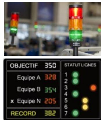
Figure 1-3 : Exemple d'Andon – Systèmes d'alerte reliés aux équipements de production – D'après l'INRS
