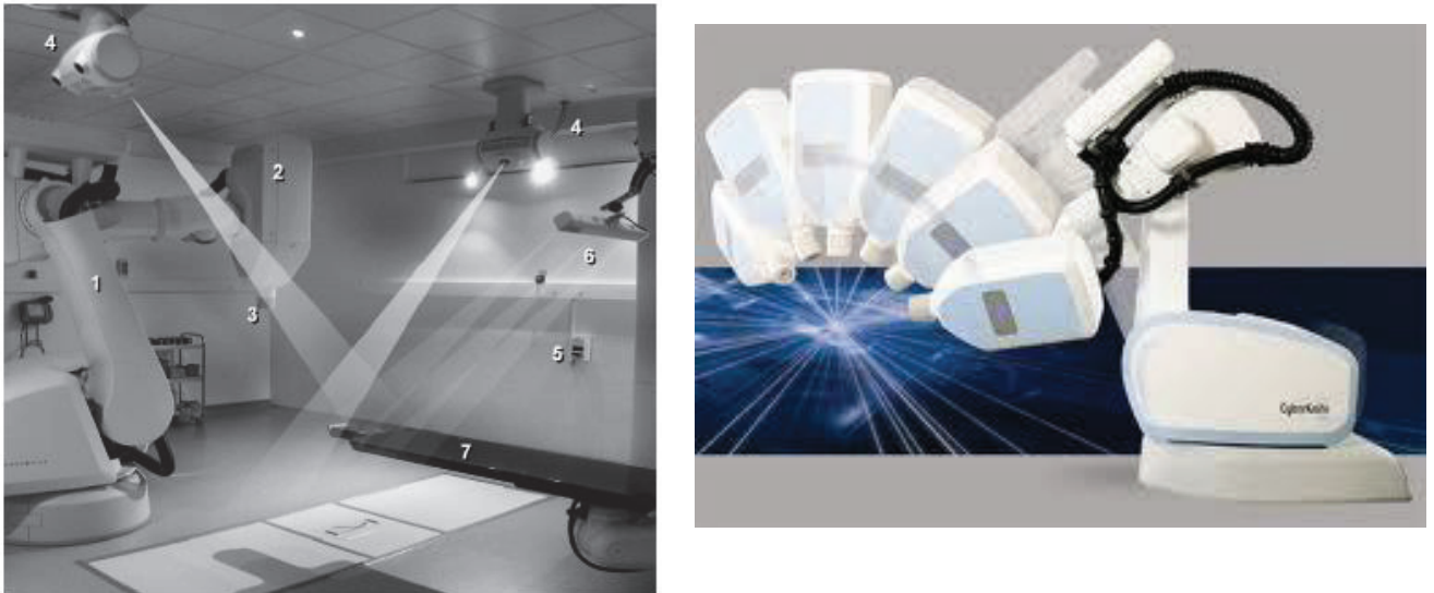
Figure 3. Architecture du Cyberknife de quatrième génération : table de traitement, robot et sa section accélératrice, tubes à rayons X et détecteurs. 17 .
