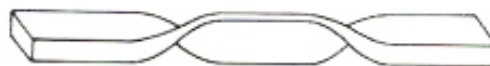
Figure 44 : Torque uniforme par courbure sur le chant d'un arc rectangulaire en deux points
