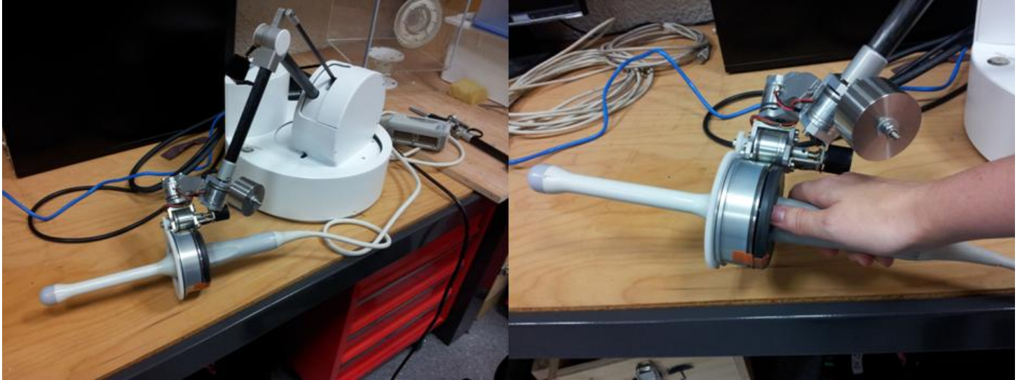
Figure 1. Prototype de robot porte sonde implémentant les fonctions de comanipulation actuellement développé dans le laboratoire ISIR
