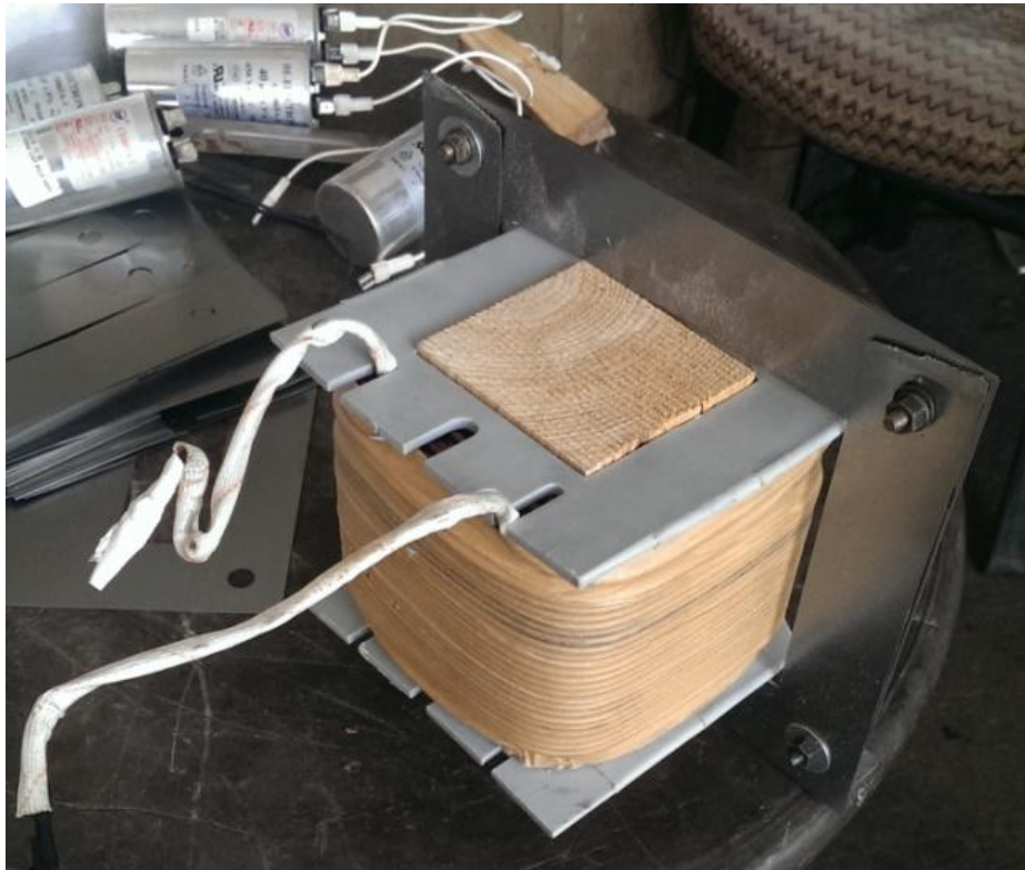
Figure IV-17 : une bobine 11mH réalisée
