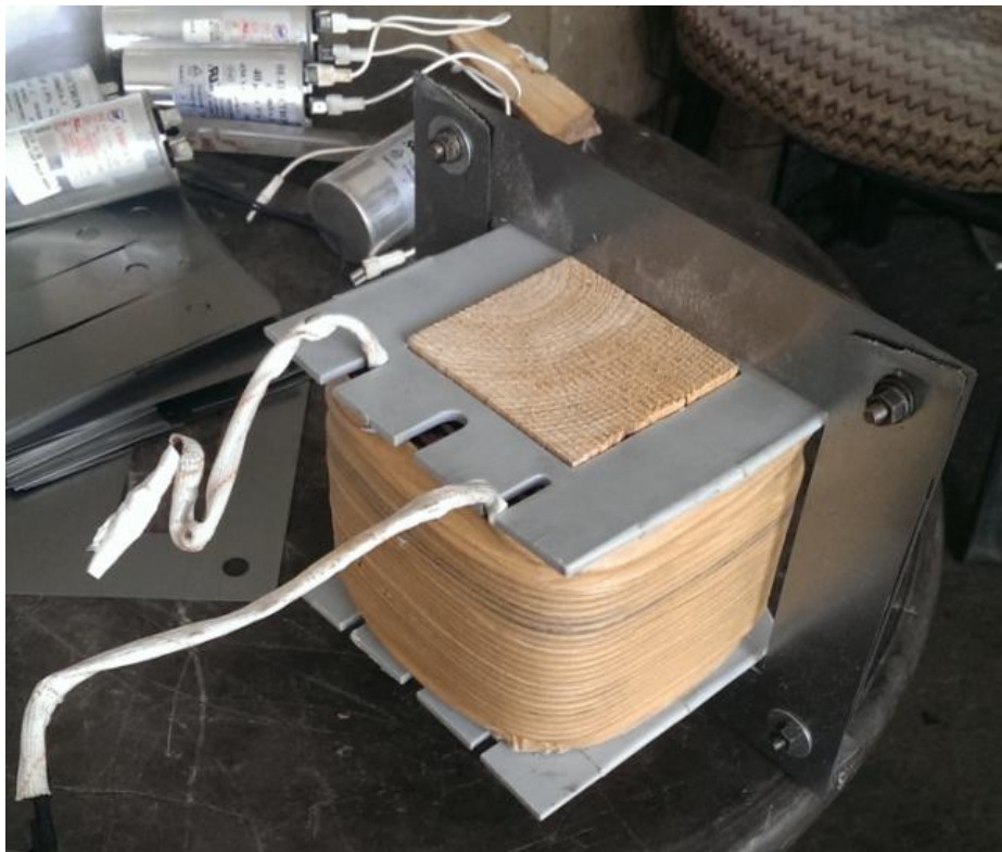
Figure IV-17 : une bobine 11mH réalisée
