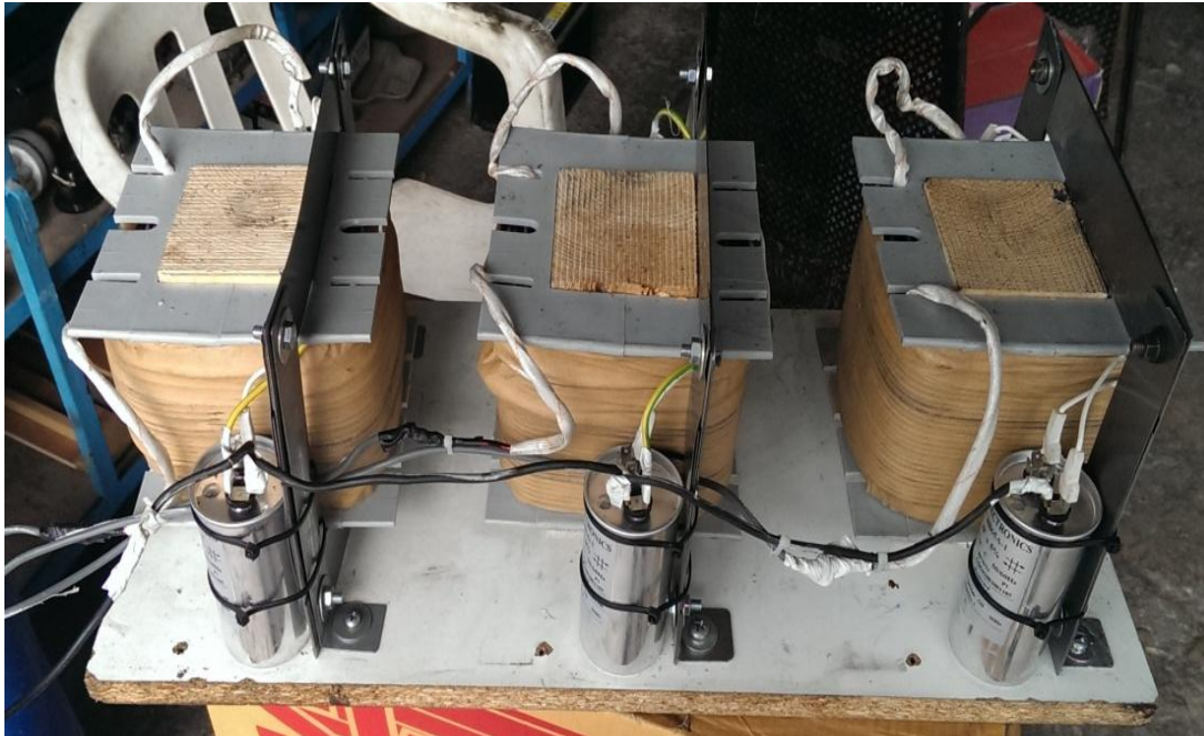
Figure IV-18 : le filtre passif réalisé.
