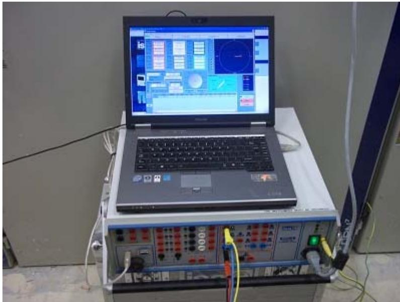
Figure 76- Machine d'essais ISA DRTS 6 pour les essais de protections
