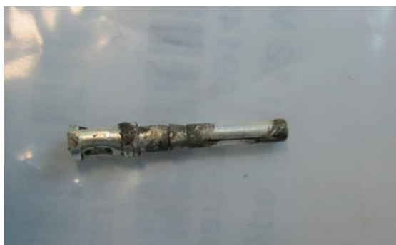
Figure 56 : Picots de prise Harting oxydés
