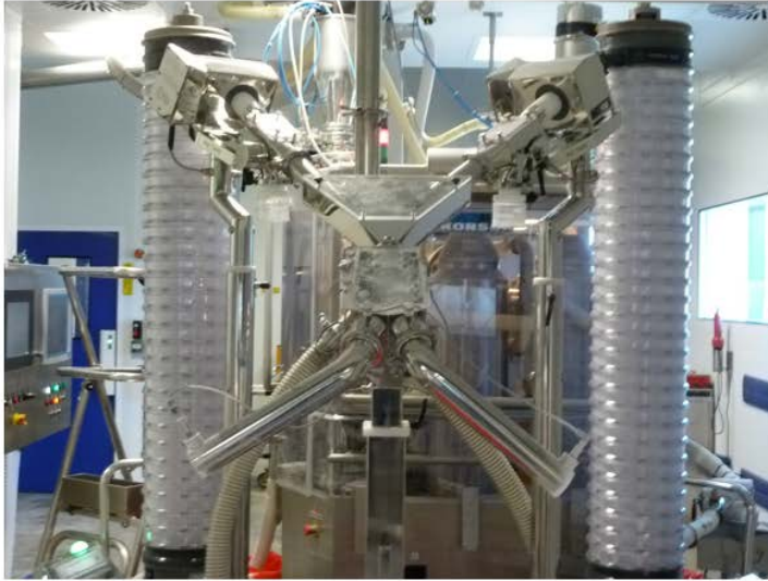
Figure 58 : Ancien système de sortie des comprimés dans Bibag
