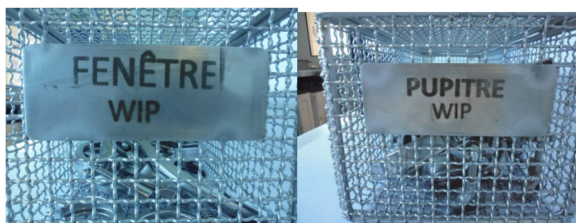
Figure 33: Marquage par empreinte electrochimique
