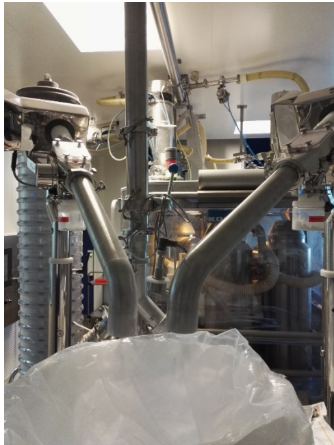
Figure 59 : Nouveau système de sortie des comprimés dans Bigbag®
