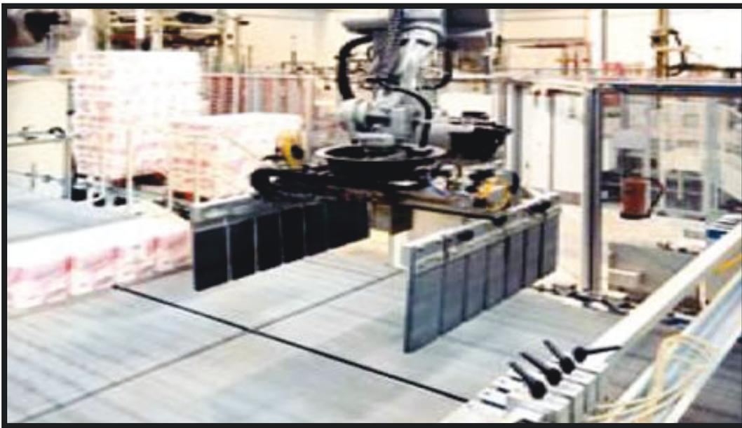
Figure- 2- Rotation avec robots anthropomorphes
