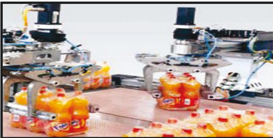
Figure -1- Rotation avec manipulateurs à 3 axes
