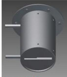
**Figure 6 : Vue isométrique du cylindre doseur.**
