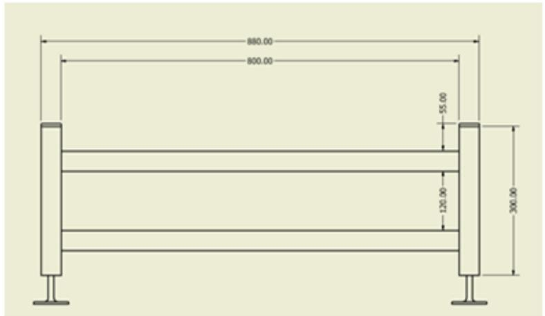
**Figure 38: Dimensions du support du convoyeur.**
