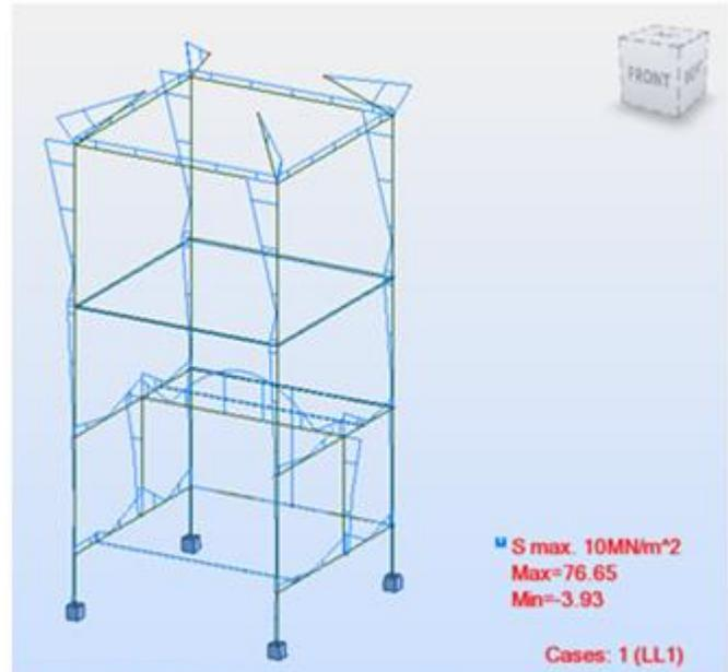
**Figure 35 :** Graphe de contrainte dans la structure.
