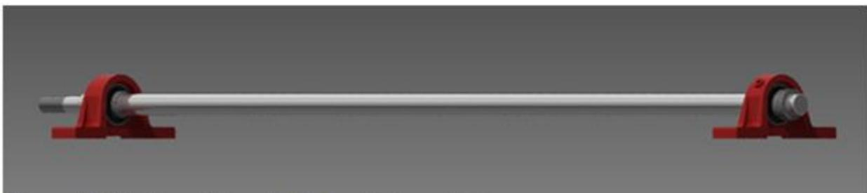
**Figure 46: Vue isométrique de l'arbre de transmission.**
