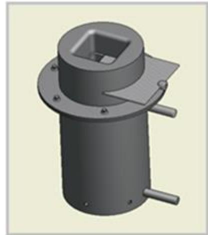
**Figure 67 :** Vue isométrique du cylindre doseur avec la pièce d'union.
