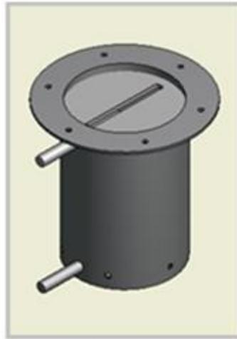
**Figure 66 :** Vue isométrique du cylindre doseur sans la pièce d'union.
