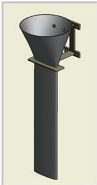
**Figure 68 :** Vue isométrique du cône d'alimentation avec le tube elliptique et son support.
