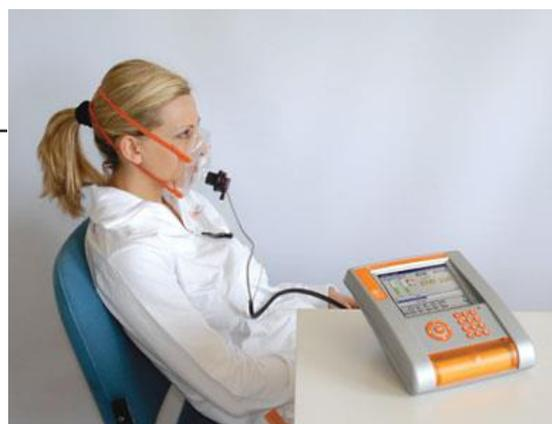
Figure 2. Calorimétrie indirecte
