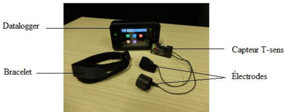
Figure 9: Appareil de mesure de la réponse électrodermale
