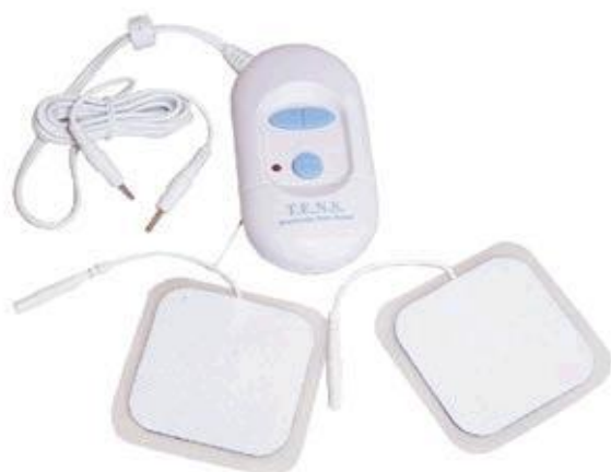
Figure 29 : Photo d'un appareil de TENS avec l'appareil (au centre) et une paire d'électrodes (en bas) ( http://www.mabels.org.uk )
