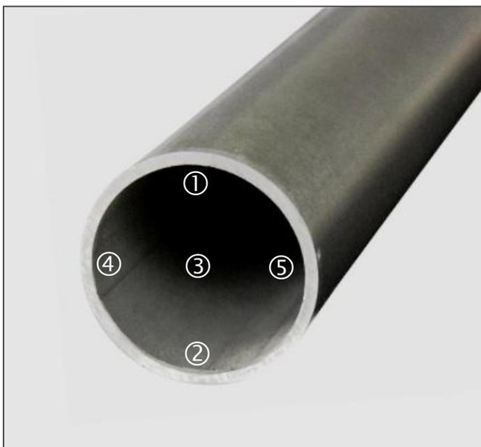
Les mesures sont effectuées par un calcul de la moyenne des débits obtenus en cinq points du tuyau concerné :
