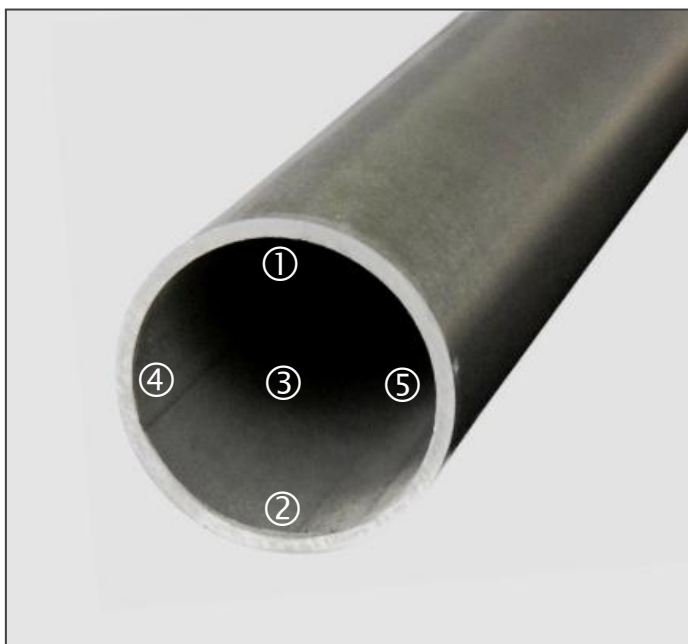
Figure 22 – Méthodologie suivie pour les mesures de débit d'air
