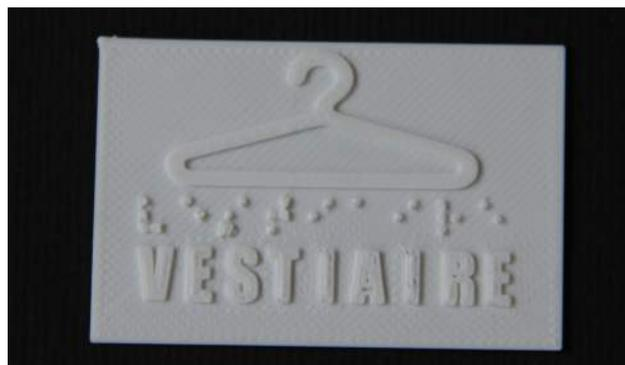
fig. 63 : Résultat d'impression du bas relief
