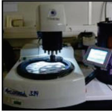
Figure 38: Polisseuse Mecatech 334<sup>®</sup> utilisée lors de notre expérience
