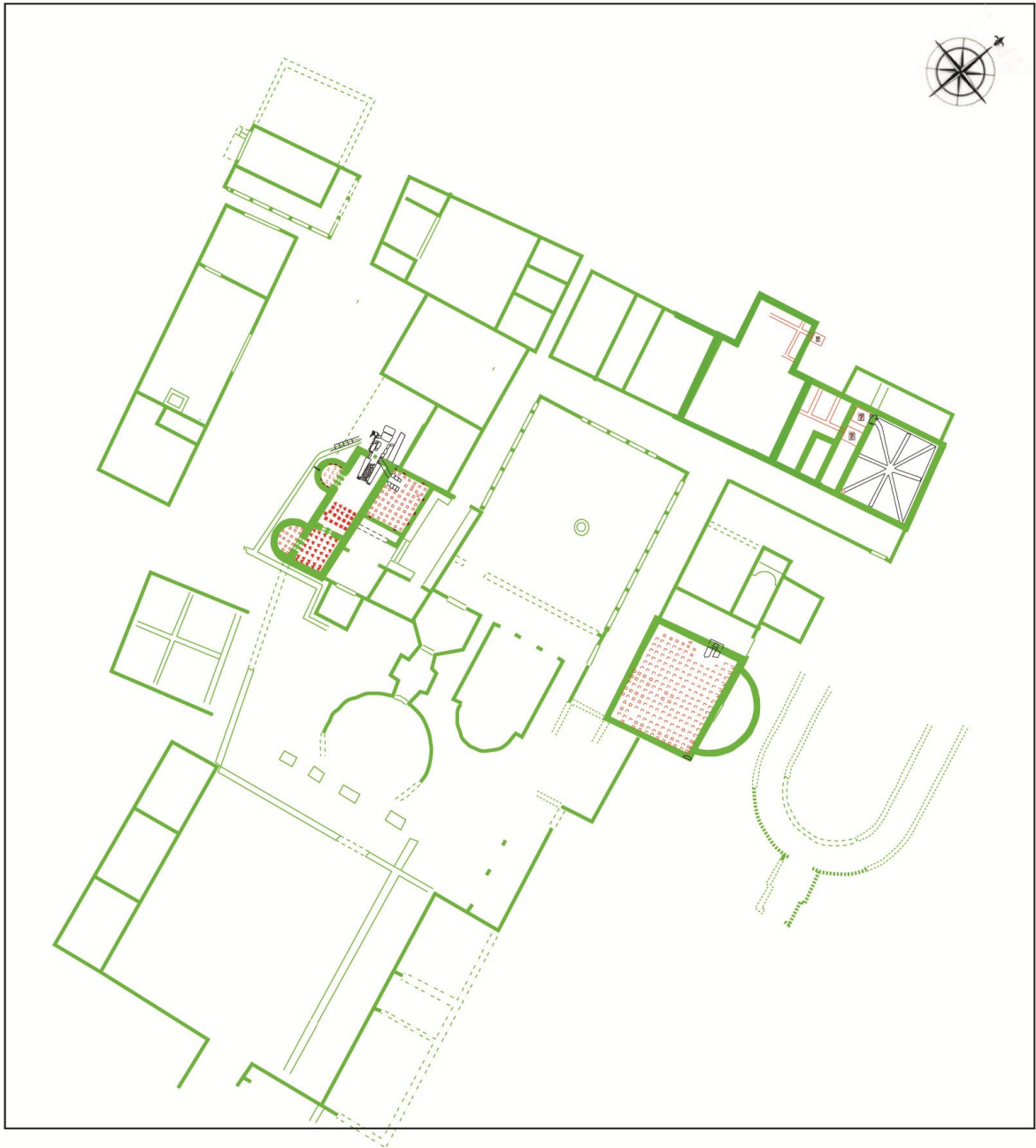
Fig. 79 : plan restitué de la villa du II e -III e s. avec emplacement des chauffages XXIV(A), V(A), XXII(A), XXIX, LXIX et XLI(A).
