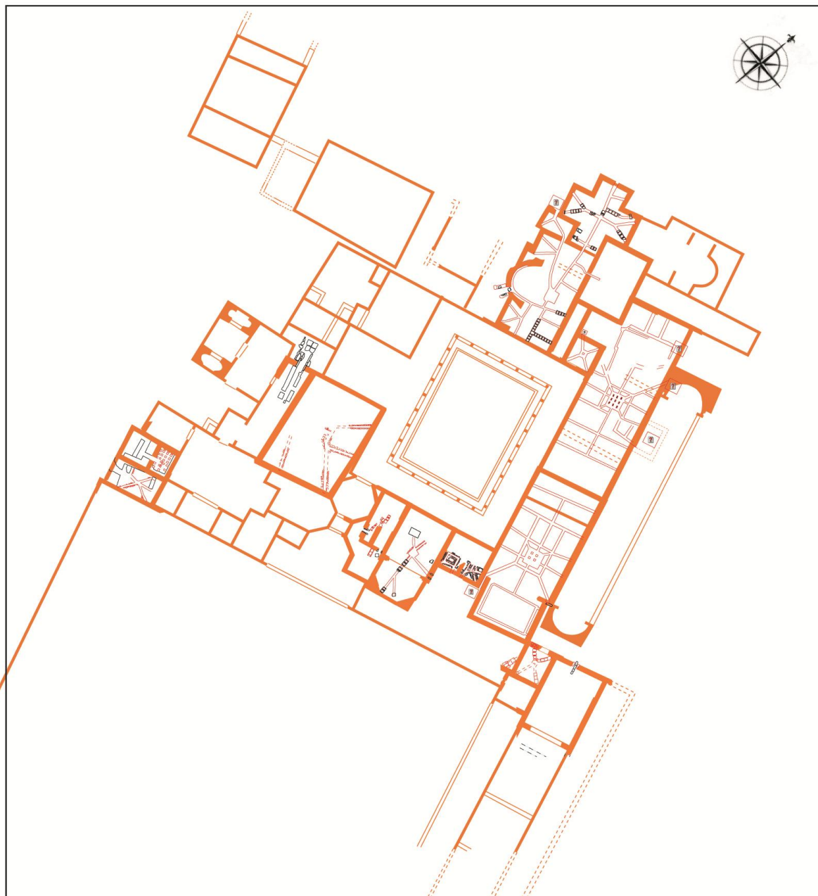
Fig. 81 : plan restitué de la villa du V e s. avec emplacement des chauffages IV-V-VII, XXXV, XXXVI, VIII, XI, XXI, XXXIX, LVIII, XXII-XXIII, XXVIII-LXIX, CVI et LXXII-XLII.
