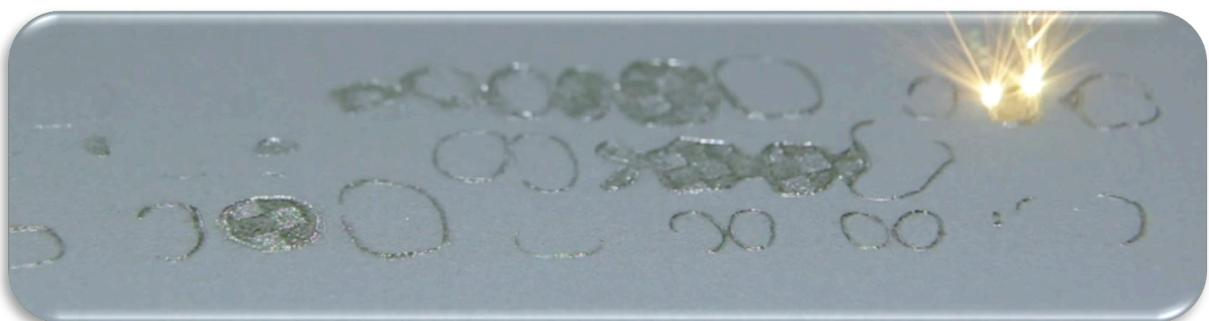
Une fois la matière consolidée, le piston supportant le modèle 3D en cours de réalisation descend de l'épaisseur de la couche réalisée.
