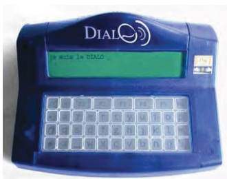
Image 5: DIALO Appareil de communication avec voix synthétique et entrée alphanumérique ou phonétique. Source : Fondation Suisse pour les Téléthèses www.fst-ch/FST/
