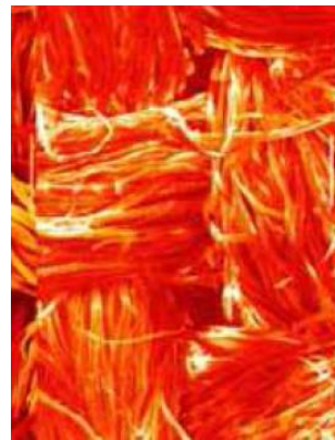
Figure 4 : Les fibres du tissu en microscopie d'après Arjowiggings
