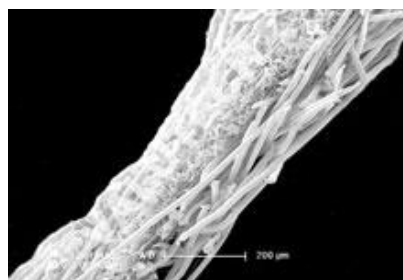
Figure 5 : Les fibres SMS d'après Valutech
