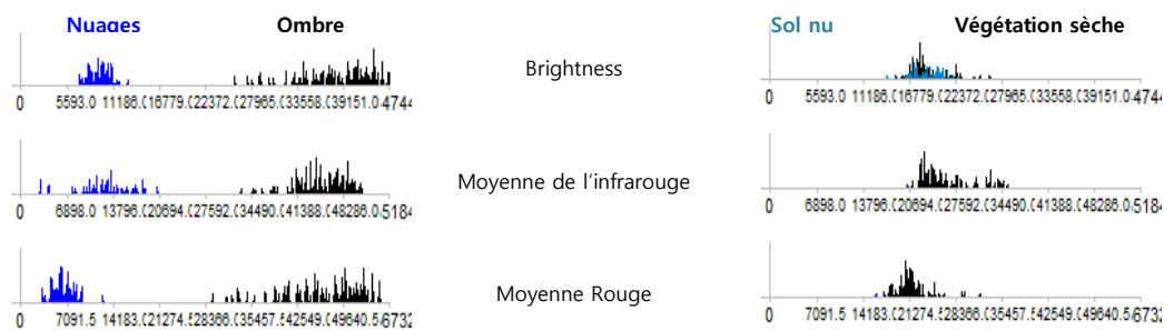
Figure 22 : Graphiques des comportements spectraux dans les couches Brightness, Proche Infrarouge, Rouge : comparaison entre les samples de différentes classes.
