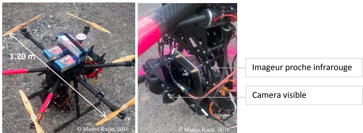
Figure 12 : Préparation de l'hexacoptère et embarquement des deux caméras Photographies prises le 25/06/2016 sur le site de Anse
