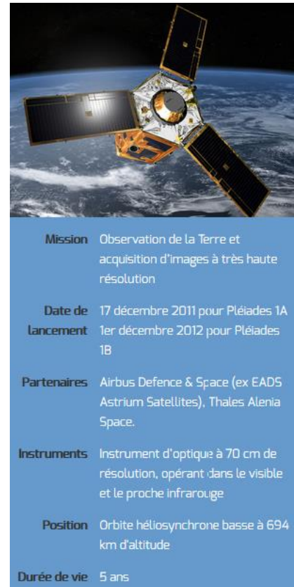
Figure 10 : Image et descriptif de la constellation Pléiades
