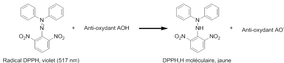
Figure 83 : Schéma de la réaction ayant lieu entre le radical DPPH et une molécule évaluée pour son pouvoir antioxydant.
