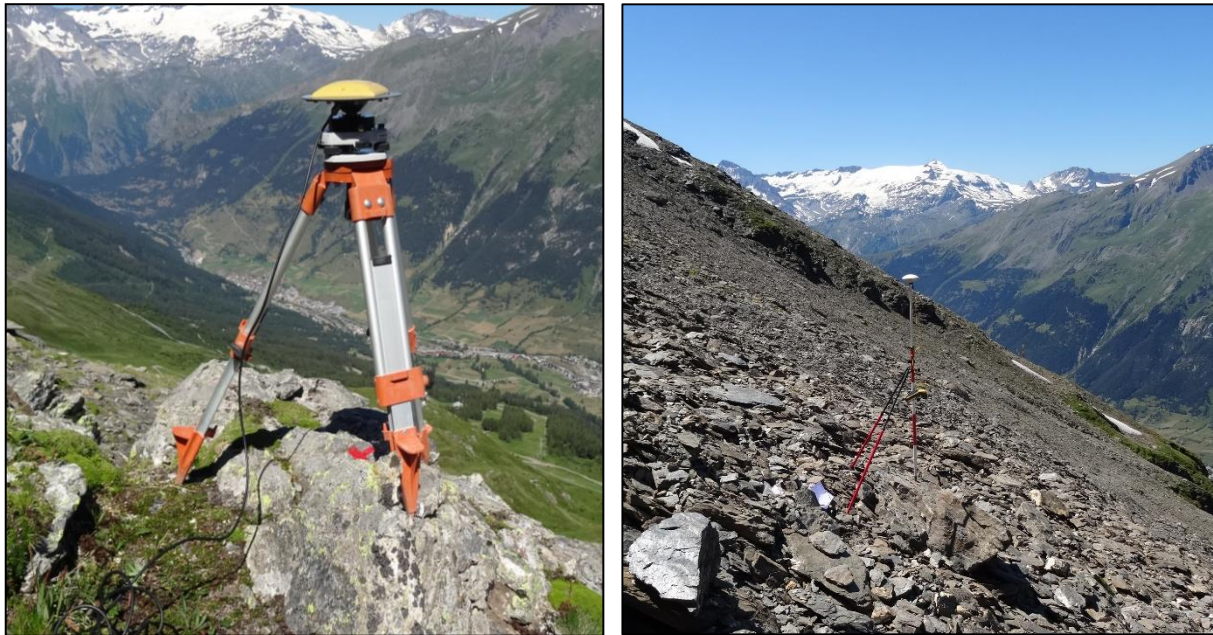
Figure 10 : A gauche : GPS base positionné sur un bloc stable durant toute la campagne de mesure. A droite : DGPS mobile en mode mesure sur un bloc du glacier-rocheux (Source : Ribeyre)
