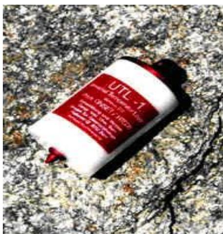
Figure 12 : Exemple de Datalogger
