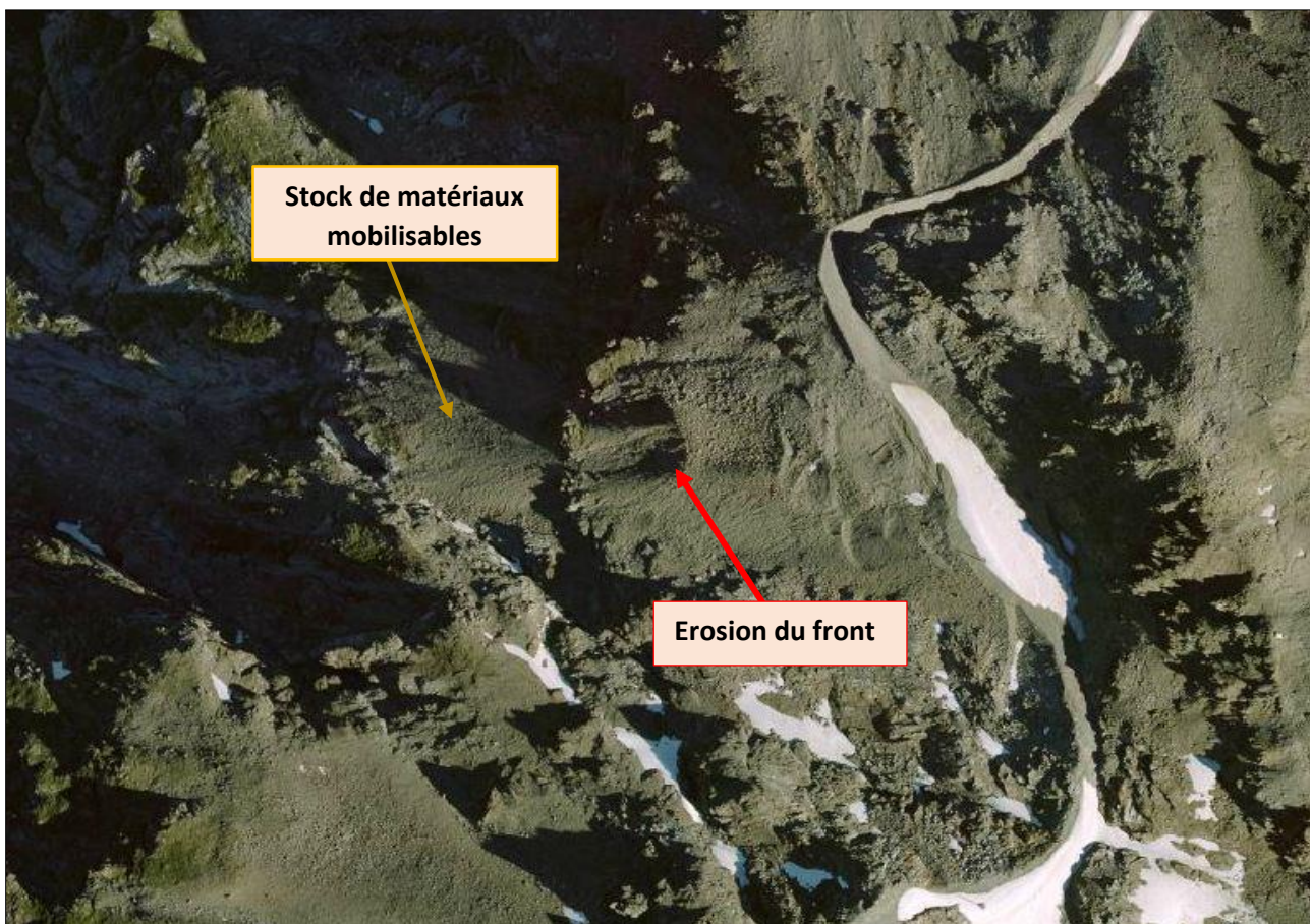
Figure 8 : Erosion du front du glacier-rocheux du Varet situé en amont de la station des Arc 2000 (Savoie). On remarque bien les apports en matériaux produits par la dégradation du front, qui sont susceptibles par la suite d'être repris par des processus de surface (torrent). (Source : image geoporatil.fr)
