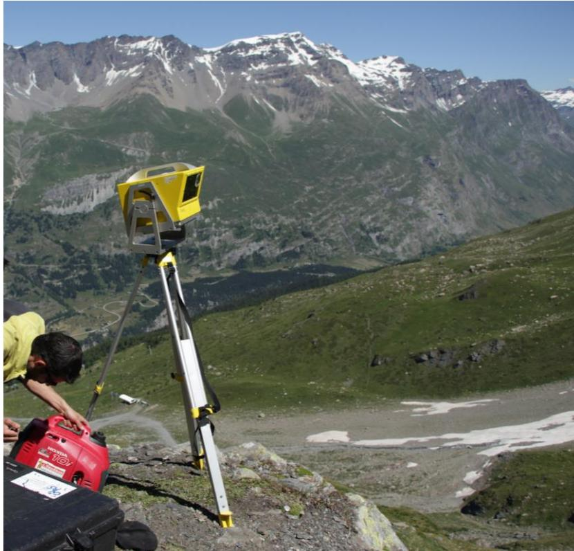
Figure 11 : Aperçu du matériel LIDAR utilisé sur le Glacier-Rocheux du col du Lou (Source : Cayla.N)
