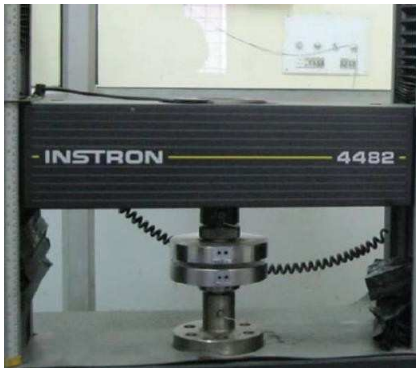
Figure 5 - Machine universelle Instron réalisant un test de compression uni-axial diamétrale
