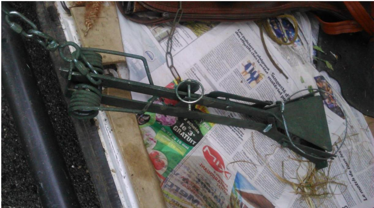
**Figure 8 : Piège à lacet, modèle « Billard ». Le triangle à droite du piège correspond à une palette sur laquelle l'animal va faire pression en se déplaçant. Le lacet qui l'entoure va alors se libérer, par un système de détente, emprisonnant l'animal par la patte. (Crédit photographique : Antoine LABÉ, 2016)**
