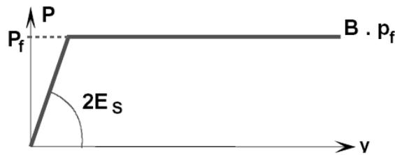
FIGURE 4-10 Courbe de réaction du sol sous sollicitations de courtes durées
