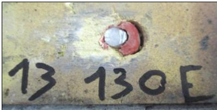
**Figure 11: Cisaillement de la fixation [7]**
