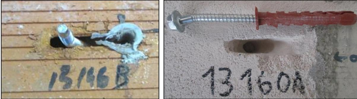
**Figure 12: Essai de cisaillement, rupture du support [7]**
