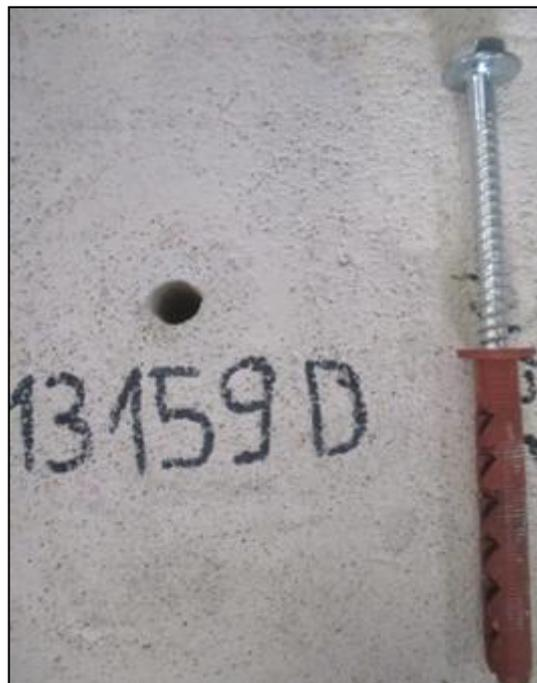
**Figure 92: Rupture fragile par casse du support (couple 2)**
