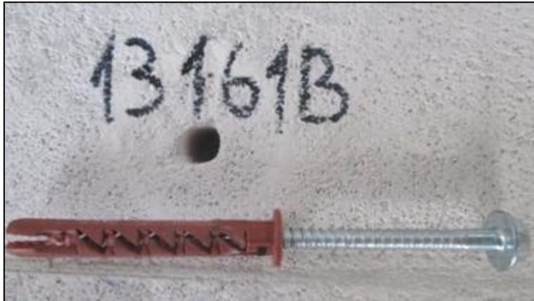
**Figure 8: Cheville mécanique extraite par glissement [7]**
