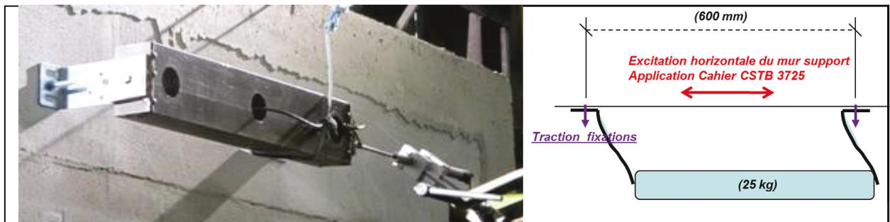
**Figure 79 et Figure 80: Corps d'épreuve utilisé pour les essais dynamiques**
