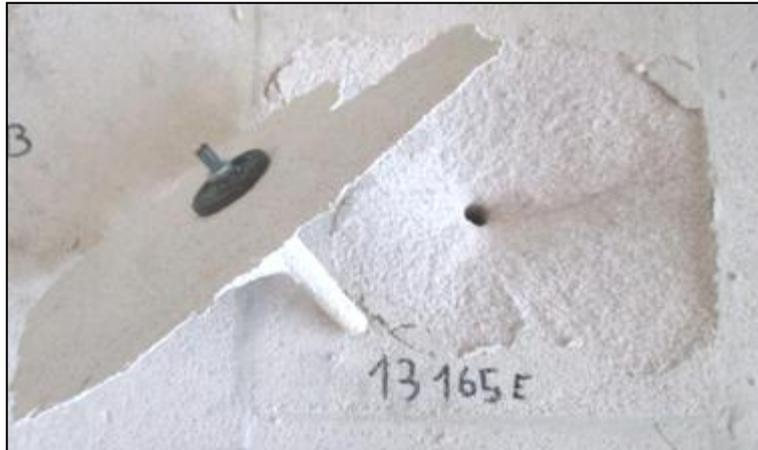
**Figure 10: Exemple de modes de rupture combinés: Rupture d'adhérence et formation d'un cône [7]**
