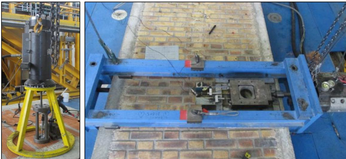
**Figure 75 et Figure 76: Dispositifs de chargement en traction et en cisaillement**
