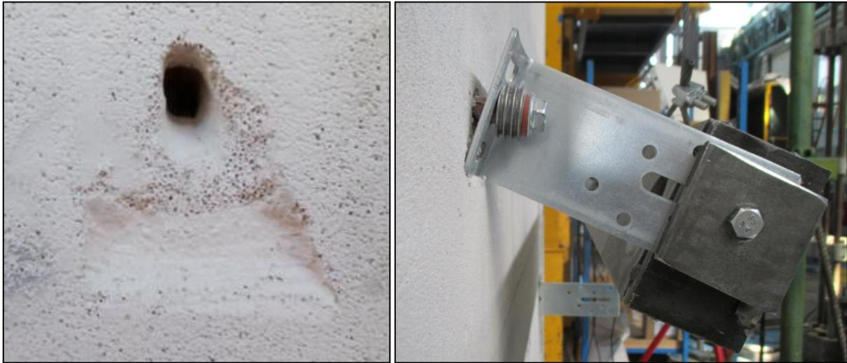
**Figure 95 et Figure 96: Rupture lors des essais dynamiques réalisés sur le couple 8**
