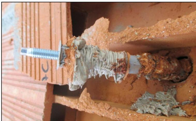
**Figure 9: Rupture par casse du support [7]**
