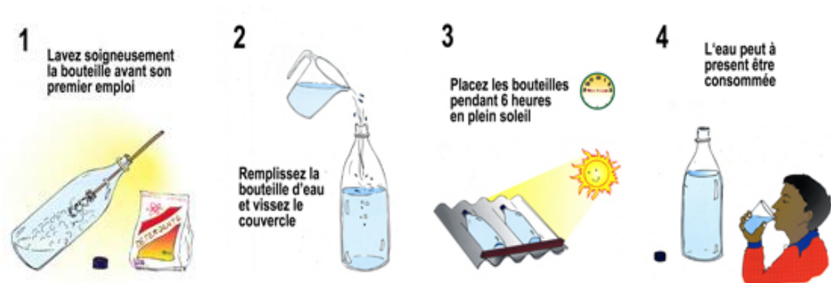
Figure 14: Stérilisation par la méthode SODIS (32)
