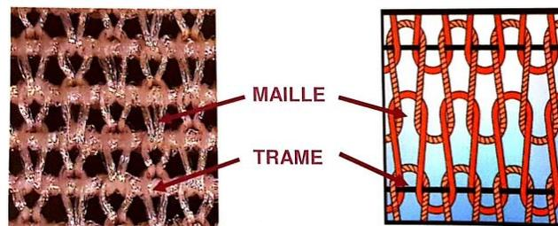
Figure 40 : Structure d'un bas médical de compression (36)
